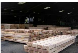
Traverses Bois sous rail
